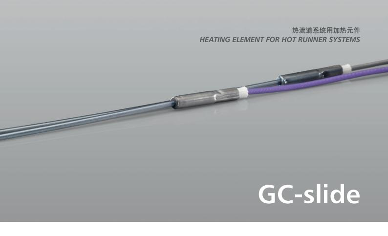
将加热元件插入薄壁套,使加热元件装入夹紧件成为一体,并用开槽的金属套提供支撑。该金属套有内锥,以便整个元件(它比喷嘴略小)自动对中并能被轻易地推上喷嘴。盘绕压缩的加热元件保证与喷嘴的最佳热接触,即使外部的径向接触压力也很低。 盘绕方式是精确设计的,以适合热流道喷嘴的具体热量要求。
